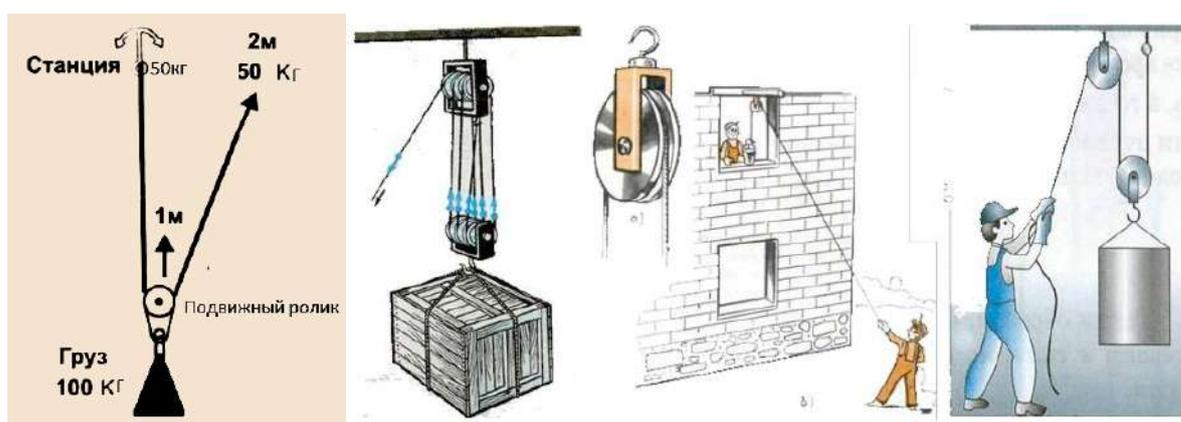
Если закрепить верёвку на станции (первая схема) и пропустить её через ролик на грузе, для поднятия груза необходимо усилие в 2 раза меньше, чем его масса. Выигрыш в усилии – 2:1. В этой схеме ролик подвижный, потому что он движется вверх вместе с грузом. Чтобы поднять груз на 1 метр, кончику верёвки необходимо переместиться на 2 метра. Это – схема самого простого полиспаста 2:1. В этой схеме нагрузка на станцию – 50 кг.
