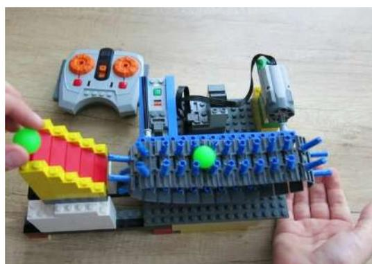
**Транспортер, элеватор** – транспортная машина непрерывного действия, перемещающая грузы в горизонтальном направлении или вверх под углом к горизонту по транспортерной ленте или в транспортных сосудах (ковшах, люльках), прикреплённых к тяговому органу.
