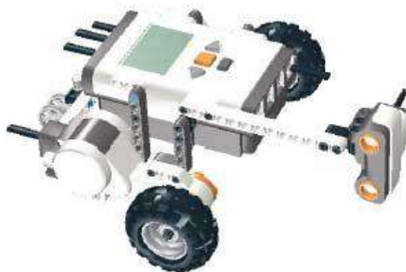
Рис. 7. Оптимальный вариант . вертикальное расположение датчика
