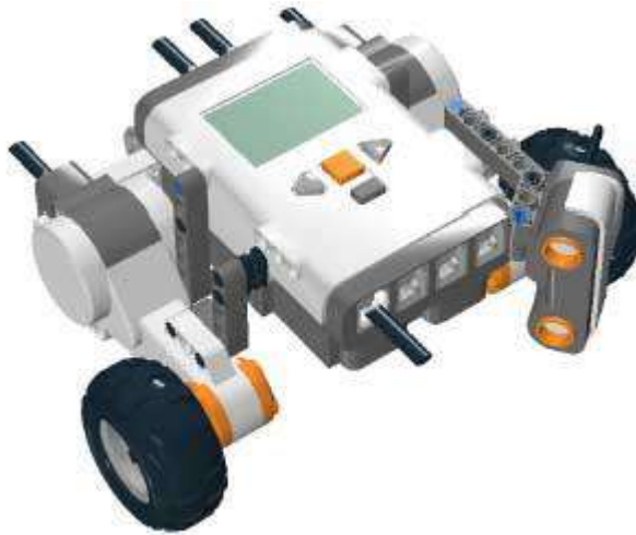
Рис. 11. Увеличенное за счет корпуса робота расстояние до стены способствует расширению области обзора
