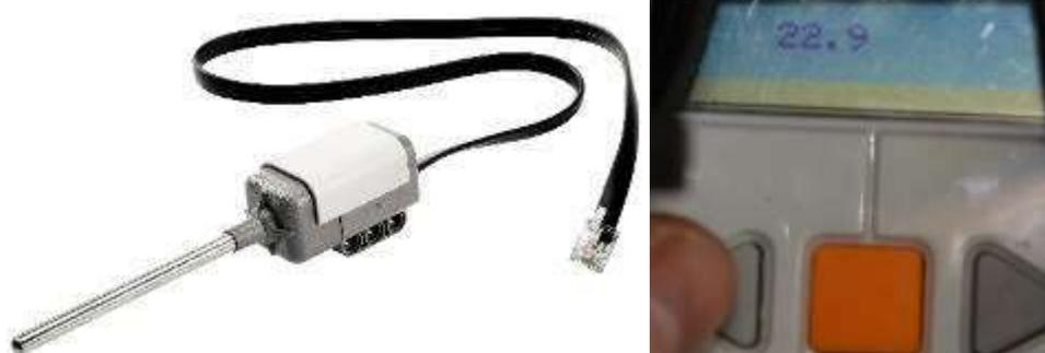
*Датчик температуры (слева) и результат измерения на экране микрокомпьютера (справа)*
