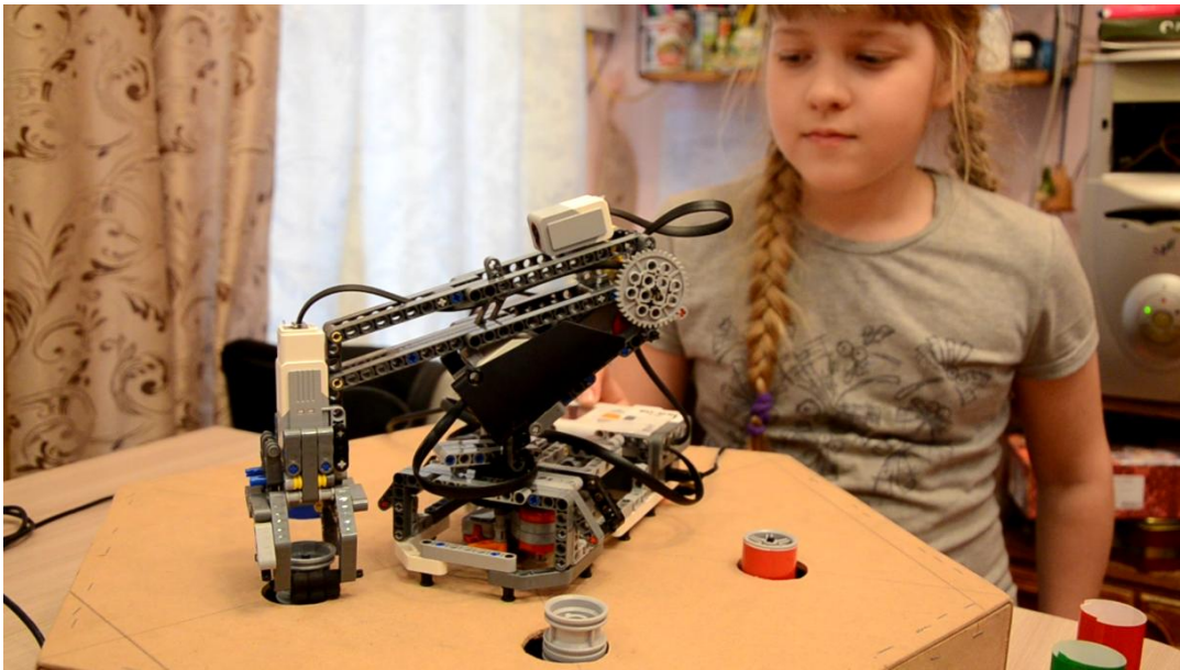
Робот-манипулятор в режиме захвата поглощающего стержня, расположенного в технологическом канале
