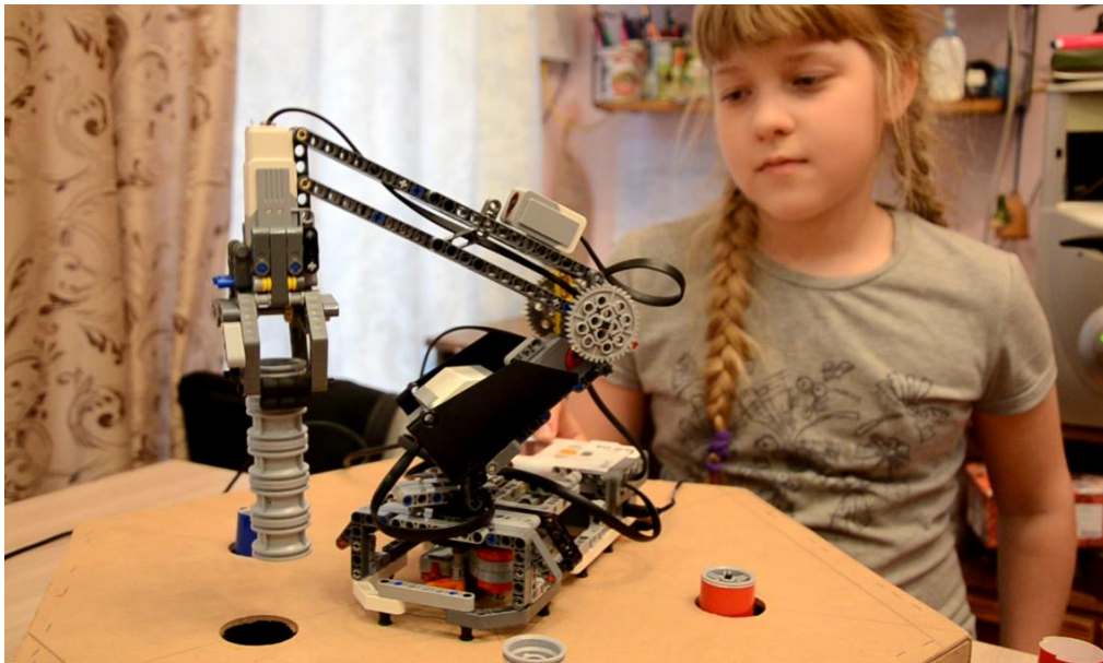
Робот-манипулятор в режиме переноса поглощающего стержня
