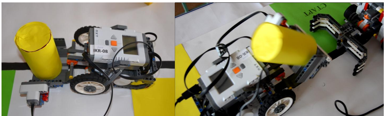
Робот в режиме ожидания бочки (слева) и в режиме перевозки с поднятым ковшом (справа)
